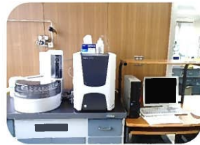
全有機炭素分析装置 水道水中に含まれる有機物を測定します。
