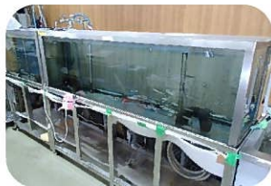
バイオアッセイ装置 水質の変化に敏感な魚類（ヤマメ）で、水質の変化を常時監視します。
