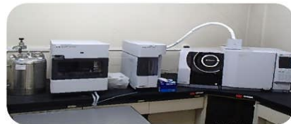
ガスクロマトグラフ質量分析装置 揮発性有機化合物（トリハロメタンなど）を測定します。
